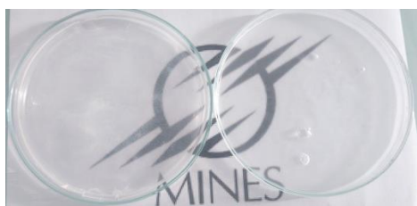
Figure 21 : A gauche PMMA/SiO 2 dispersion via un bain US – A droite PMMA/SiO 2 dispersion via une sonde US
