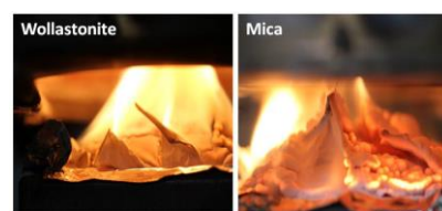
Figure 65 : Apparition des plaquettes lors d'un essai au feu à 50 kW.m -2 pour des composites contenant du mica ou de la wollastonite.
