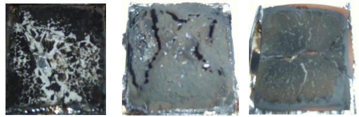
Figure 42 : Aspect des résidus après essais au cône calorimètre, résine polyester insaturé pure (à gauche), avec 1,0%S1 (au milieu) et combinant 1,0%S1 + 60wt% ATH (à droite)
