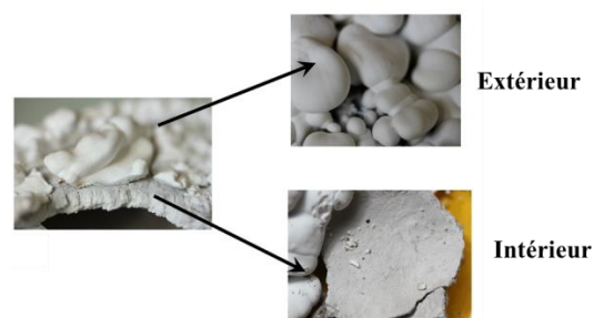
Figure 64 : Formation de deux couches (a- à la surface et b- à l'intérieur) sur les résidus de composite de silicone après un test au cône calorimètre
