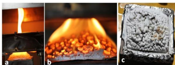
Figure 63 : Essais au feu au cône calorimètre (a, b) et résidu obtenu en fin de test (c) à 50kW.m -2 .
