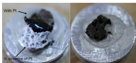
Figure 66 : Résidus obtenus en fin d'analyse thermogravimétrique sous N_2 à 900°C.
