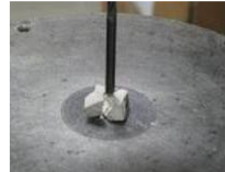
Figure 60 : Visualisation d'un essai de compression sur un résidu de silicone.
