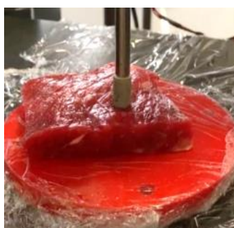
Figure 7 : Relaxation (maintien en position de la pointe et mesure de l'évolution de la force au cours du temps.)
