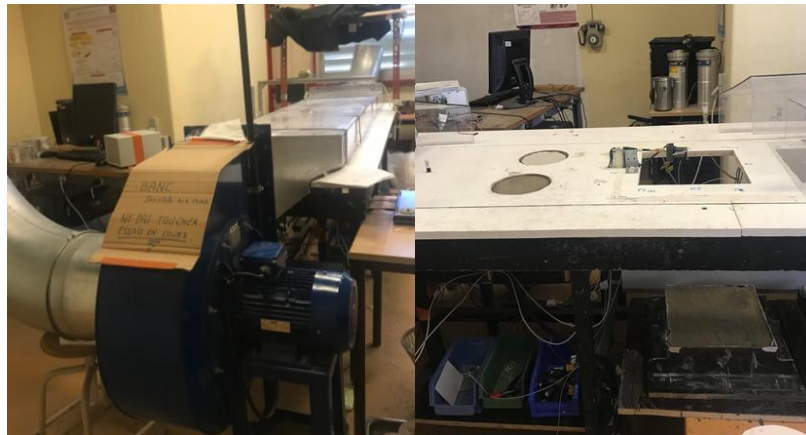
FIGURE 1. Banc de test pour la production d'un flux de vent (à gauche turbine, à droite, moules et moyens de mesures)
