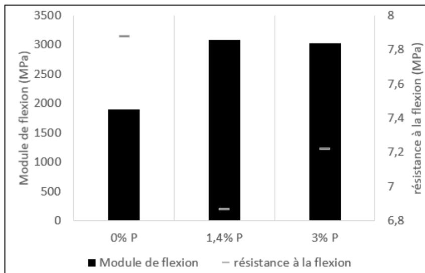
Fig. 2 : Propriétés mécaniques des panneaux d'épicéa traités
