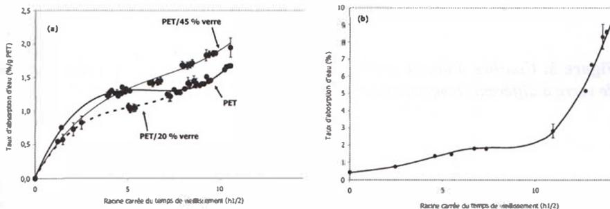
**Figure 2.** Évolution du taux d'absorption d'eau de la matrice PET et de composites PET/verre avec différents taux massiques de fibres de verre au cours d'un vieillissement par immersion dans l'eau à 120 °C selon les deux méthodes de mesures (a) gravimétrie ; (b) dosage Karl Fisher
