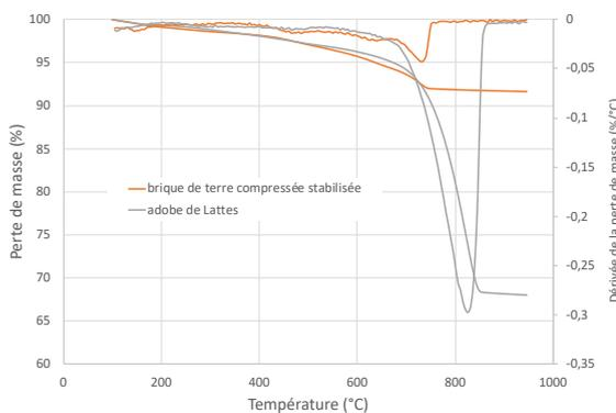
FIGURE 5. analyse thermogravimétrique
