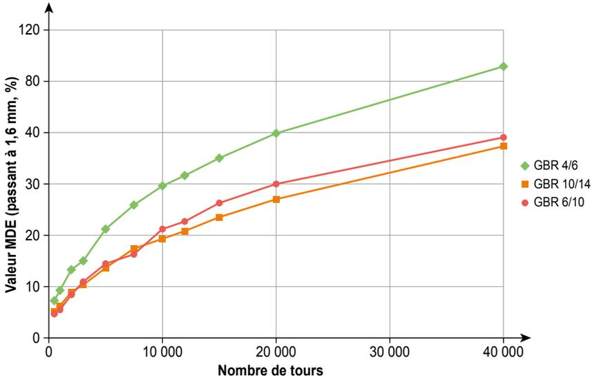
billes métalliques du MDE provoquent : i) l'abrasion préférentielle des grains de tailles similaires aux billes (10 mm) ; ii) un mécanisme de clivage pour les grains plus petits, comme ici ceux de la classe 4/6.
