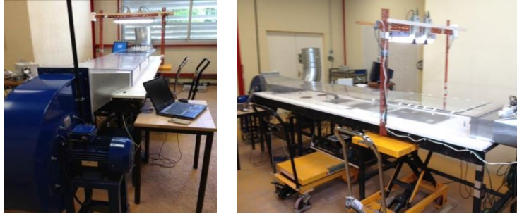
Figure 1. Banc de séchage, vue de face et vue générale
