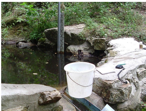
Figure 1 : Échelle limnimétrique sur le site des Bastides (crédit photo : J-F DIDON-LESCOT).
